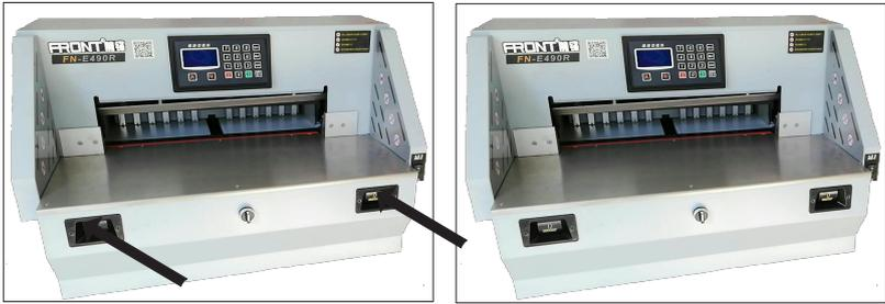
确认好尺寸，就可以进行裁切了，俩手分别按裁切按钮，压纸器开始压纸，压好纸后开始下刀裁切，当发现有误时，立即停止按钮，切刀和压纸器会自动停止，按RESET复位，确认无误时按住按钮直至裁切完成；
