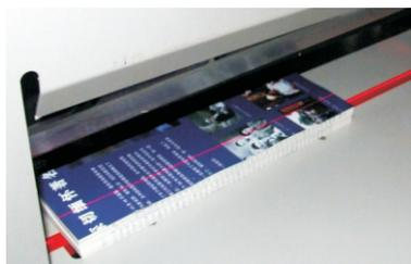
将电器保护开关拨至“ON”位，显示屏有显示，刀位指示线亮，显示屏显示“PLEASE RESET”表示需要按复位键一次，压纸器、切刀、推纸器自动校准，表示进入正常工作状态。
