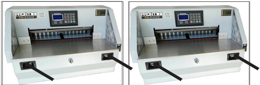
是否推纸在不同模式下会有不同结果：a. 手动模式，裁切完成后，再按推书键，机器会自动将书推出来；b. 自动模式，如果之前设定好了切完纸后自动推纸，那么此次裁切完成后，推纸器会自动将书推出来，若之前没有设定自动推纸、再按推书键，推纸器会自动将书推出来，接着推纸器移动到下一组数据的位置；c. 分段模式，裁切完成后，紧跟着切第二刀，直至将纸张切完为止；
