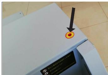
如调节切刀深度微调还不能切断一张纸时，只能再调节切刀深度平衡螺丝；卸下上罩两端固定螺丝，取下上罩；
