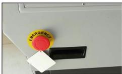
急停开关，紧急情况下使用，当处理好后，重新按下急停开关，再按复位键复位，即可进入工作状态。
