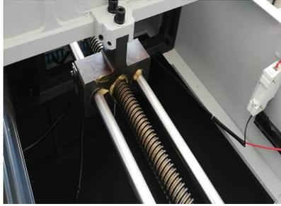
检查步进电机，卸下前盖板，同步带轮、同步是否固定正常；
