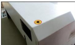
用一张复印纸 80g 的纸来进行试切，如裁切不断，可调节切刀深度微调装置（调节深度范围±5mm左右）。
