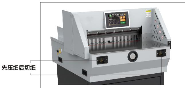
确认好尺寸后，就可以就行裁切，两手分别按裁切按钮，压纸后开始裁切（直接两手分别按裁切按钮，压纸器开始压纸，压纸后开始裁切），当发现有误时，松开按钮，按复位键复位机器，确定无误继续按住裁切按钮完成裁切；
